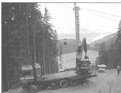
Abb. 2: Kombinationsmaschine zur weitgehenden Mechanisierung der Holzernte
