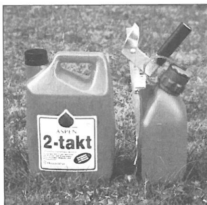
Abb.1: Der neue Arbeitskanister besteht aus einem Kombihalter mit Kettenölbehälter und dem schnell austauschbaren 5 Liter - Kraftstoffbehälter.
