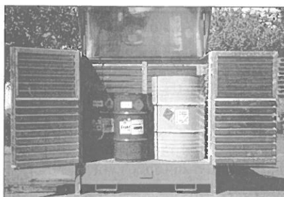
Abb. 3 Solche Gefahrgutcontainer zur Lagerung von Sonderkraftstoff können bei der Einlagerung von 5-Liter Gebinden auch mit Einlegeböden ausgestattet werden.
