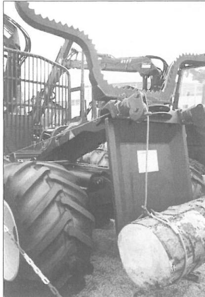
Das hydraulisch ausschwenkbare Rückeschild des Kombinationsschleppers TS 14.6 der Firma Dasser
