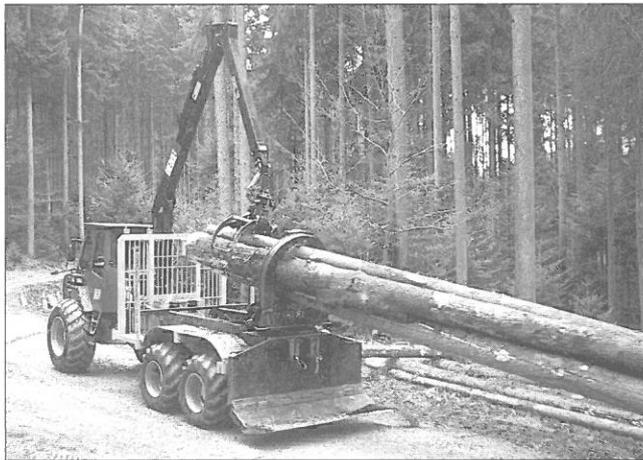
Der FORCAR FC 150 kann innerhalb von 15 Minuten vom 10t-Tragschlepper zum Rückeschlepper mit Klemmbank umgerüstet werden.
