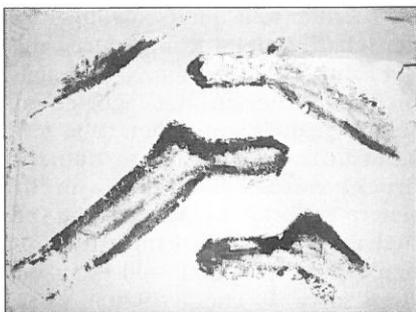
Abb.1: Kontaktflächenabdrücke von Forstmaschinenreifen nach o.g. Verfahren.
