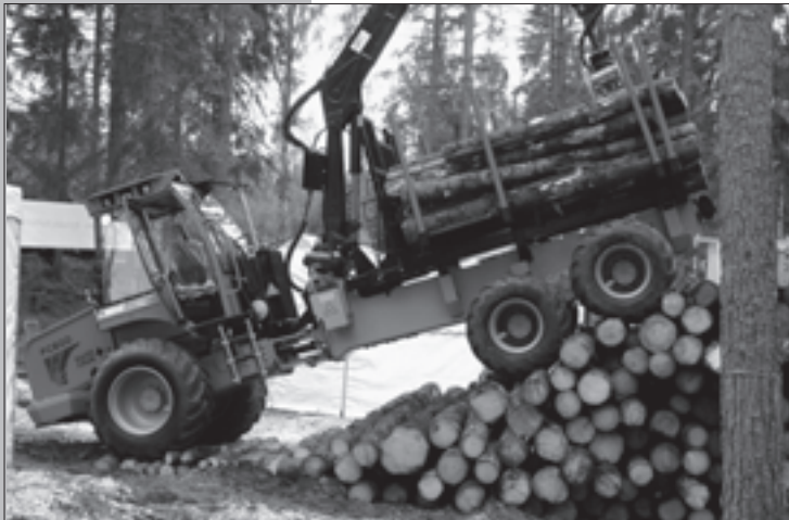
Abb. 4: Forcar FC 200 von Klaus Herzog aus der Schweiz kann schlupf-frei am Hang rücken. Auf der Elmia Wood gab's keine Hänge... (Foto: Mühlhausen / Silvapress)
