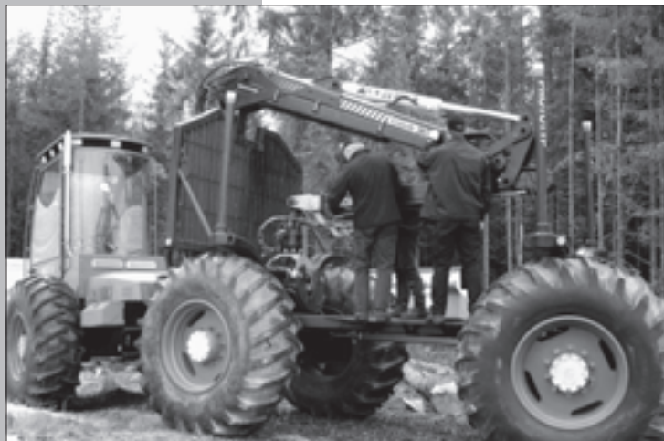
Abb. 5: EL Forest; Forwarder mit Elektromotoren in den Radnaben (Foto: Mühlhausen / Silvapress)
