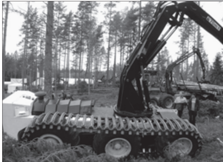
Abb. 6: Fahrerloser Harvester Beast, der von einem der beiden Forwarder aus gesteuert wird – wohl nichts für unsere Wälder. (Foto: Mühlhausen / Silvapress)
