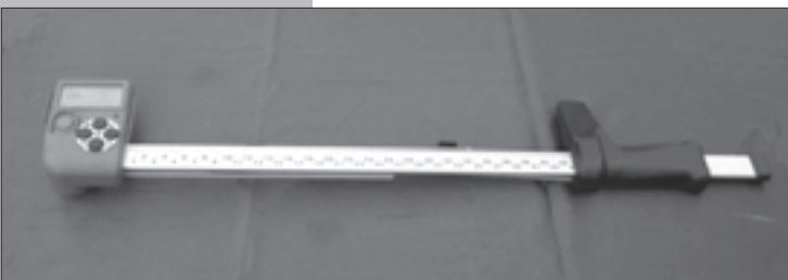
Abb. 3: Klappbare Messschenkel der Haglöf-Kluppe Digitech Professional reduzieren das Beschädigungsrisiko beim Transport.
