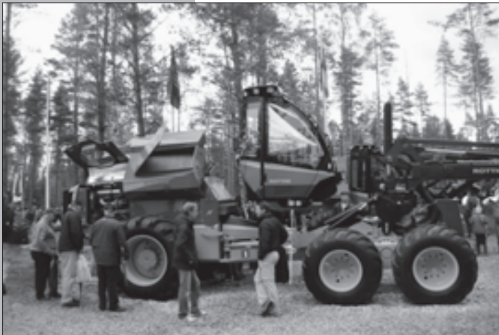
Abb. 2: Ein Beispiel für hohe Wartungsfreundlichkeit beim Rottne H 14; die komplette Karosserie kann zur Seite geklappt werden (Foto: KWF).
