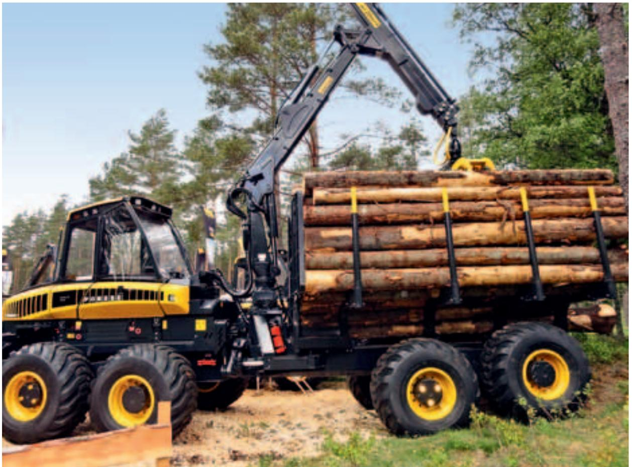
Abb. 1: Der neue 20-Tonnen Forwarder Elephant King rundet die Modellpalette von Ponsse nach oben ab
