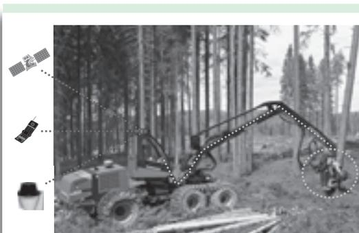
Abb. 7: Leistungsfähige Sensorik und die Datenbanken des Virtuellen Waldes ermöglichen die besitzerscharfe Abrechnung der Holzernte
