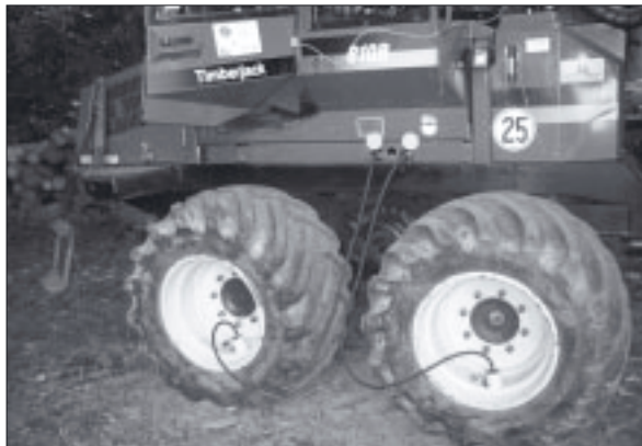
Abb. 1: Reifendruckregelsystems zum Anpassen des Reifeninnendrucks
