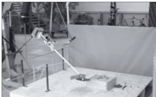
Abb. 2: Versuchsaufbau Freischneider mit Fremdkörper-einwirkung
