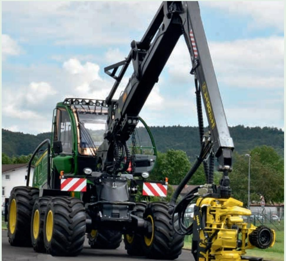
Abb. 3: Harvester „John Deere 1270 G 6-Rad-Version“ (Foto Weise)
