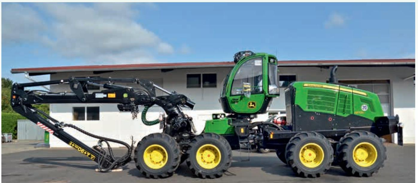
Abb. 4: Harvester „John Deere 1270 G 8-Rad-Version“ (Foto Weise)
