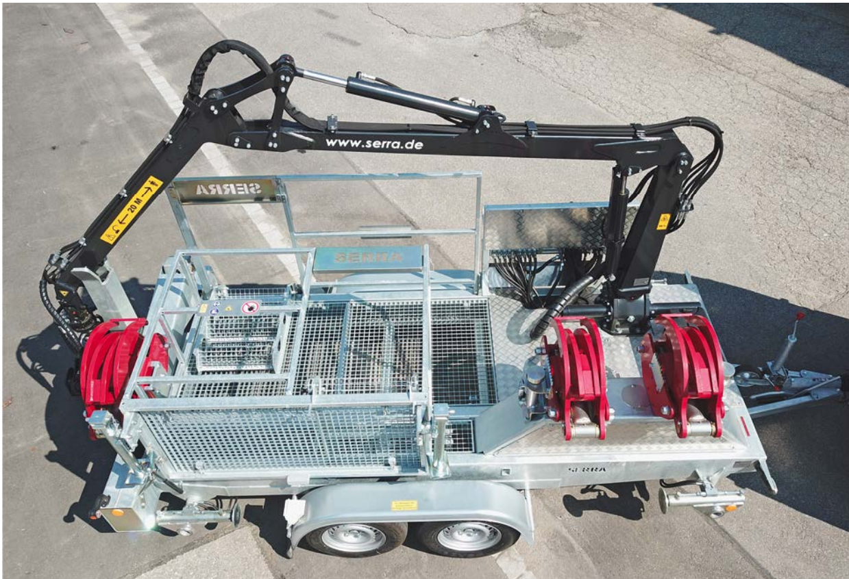
Abbildung 2: Serra Cut Coach in Transportstellung
