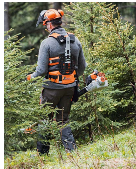
Abbildung 3: Doppelschulter-Gurtsystemen aus dem Zubehörprogramm des Herstellers, Foto: Stihl
