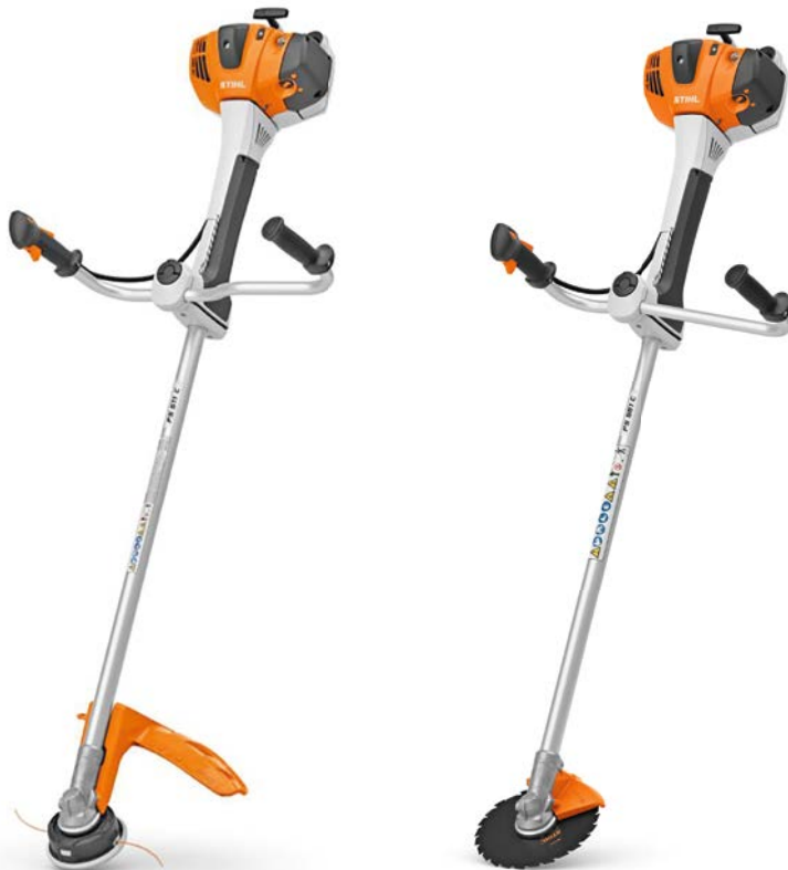
Abbildung 1 und 2: v.l.n.r. Freischneider FS 511 und FS 561 (Sägeausführung), Fotos: Stihl
