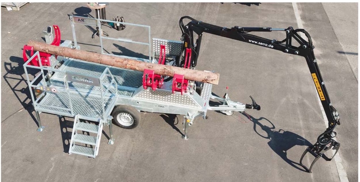
Abbildung 1: Spannungssimulator Serra Cut Coach in Arbeitsstellung
