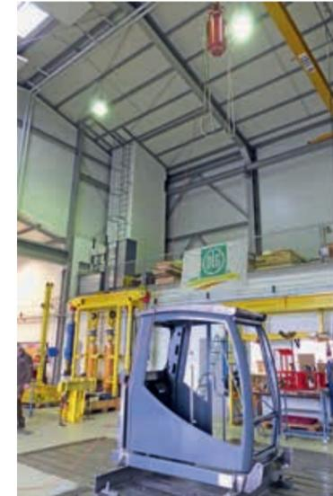
Abbildung 7: Prüfaufbau für die FOPS-Prüfung einer Forstmaschinenkabine mit einem Energieniveau von 11.600 J. (Foto Deutsche Landwirtschafts-Gesellschaft DLG)
