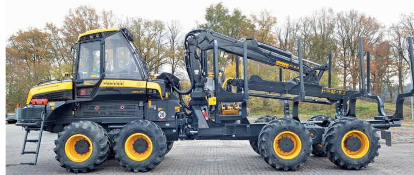
Abbildung 2: Forwarder mit typischer Forstmaschinenkabine und integriertem Kabinenschutz – FOPS geprüft mit Energieniveau 11.600 J (Foto Weise)
