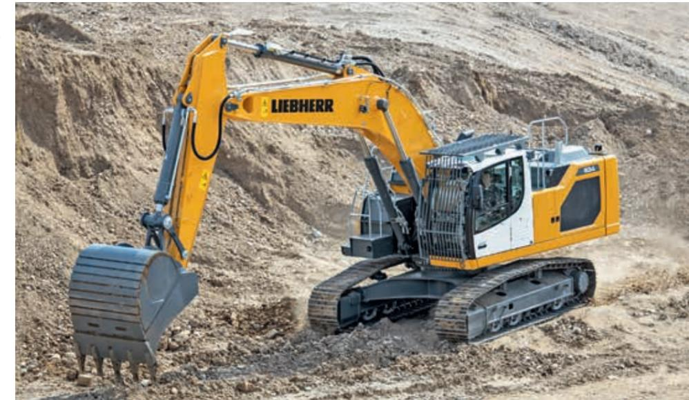
Abbildung 3: Bagger mit typischem zusätzlichem Kabinenschutz (FOPS-Gitter); Wiedergabe erfolgt mit freundlicher Erlaubnis von Liebherr International Deutschland GmbH
