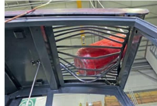
Abbildung 8: Schutzvorrichtung nach erfolgter FOPS-Prüfung und links Messvorrichtung zur Überprüfung des Überlebensraums (DLV). (Foto Deutsche Landwirtschafts-Gesellschaft DLG)
