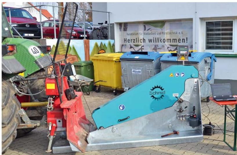
Abbildung 7: Seilwindenprüfeinrichtung Ropo-Check 100 Bauart Schmid Maschinenbau & Landtechnik (Foto Weise)
