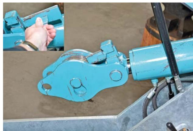
Abbildung 8: Modifizierter Hydraulikzylinder für die Zugkraftmessungen der Seilwindenprüfeinrichtung Ropo-Check 100 Bauart Schmid Maschinenbau & Landtechnik; Detailbild Keilschloss zur Seilbefestigung (Abbildung Weise)
