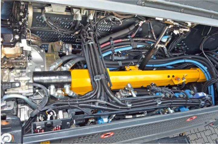
Abbildung 4: Antriebswelle vom Motor zum CVT-Getriebe in der Maschine Ponsse Bison; erkennbar sind noch 2 Kühlumlaufpumpen. (Foto Weise)
