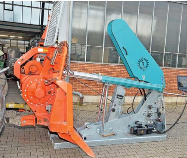
Abbildung 9: Seilwindenprüfeinrichtung Ropo-Check 100 mit patentierter Seilbefestigung für hohe Auszugskräfte und weiteren optionalen Zusatzeinrichtungen für Windenprüfungen bis 200 kN Zugkraft und elektrischer Belastungspumpe (Foto Weise)
