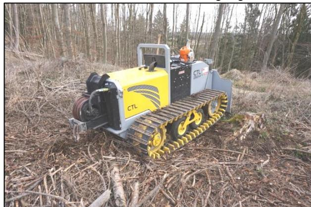
Abbildung 9: Seilunterstütztes Vorrücken mittels Raupe - Foto: S. Waas, LWF
