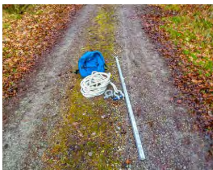
Abb. 6: Ausrüstung für die Königsbronner Anschlagstechnik
