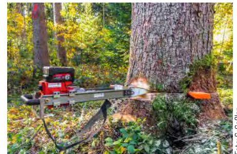
Abb. 8: Mechanischer Fällkeil im Schnabelschnitt
