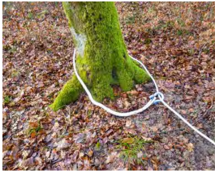
Abb. 3: Anschlagseil und Schäkel
