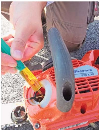
Abbildung 3: Ermittlung des Kettenölverbrauchs der Motorsägen mittels Kunststoffspritze
