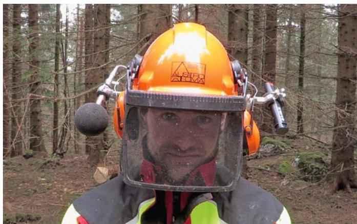
Abbildung 4: Mikrofonmontage zur Schallpegelmessung am Forsthelm, Miniatur-Schallpegelmesser Svan 971 mit Mikrofon und Windschutz
