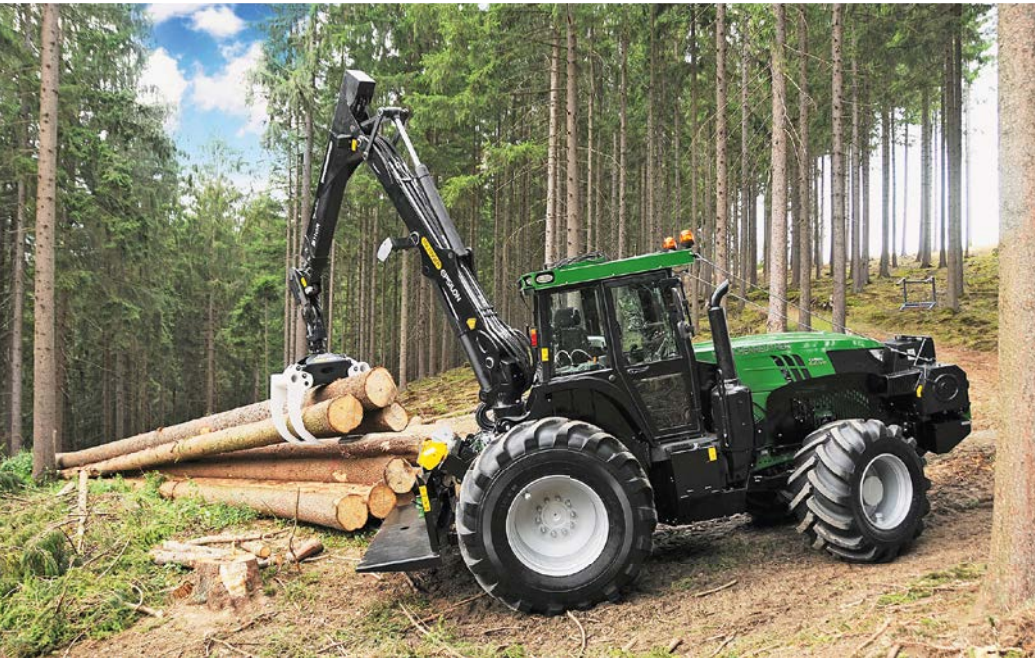
Abbildung 1: Kranrückeschlepper Typ „Kotschenreuther 220 R“ (Werkbild Kotschenreuther)
