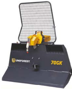
Abbildung 9: Eintrommel Getriebe-Anbauseilwinde für den Frontanbau Typ „Uniforest 70 GK“ (Werkbild Uniforest)
