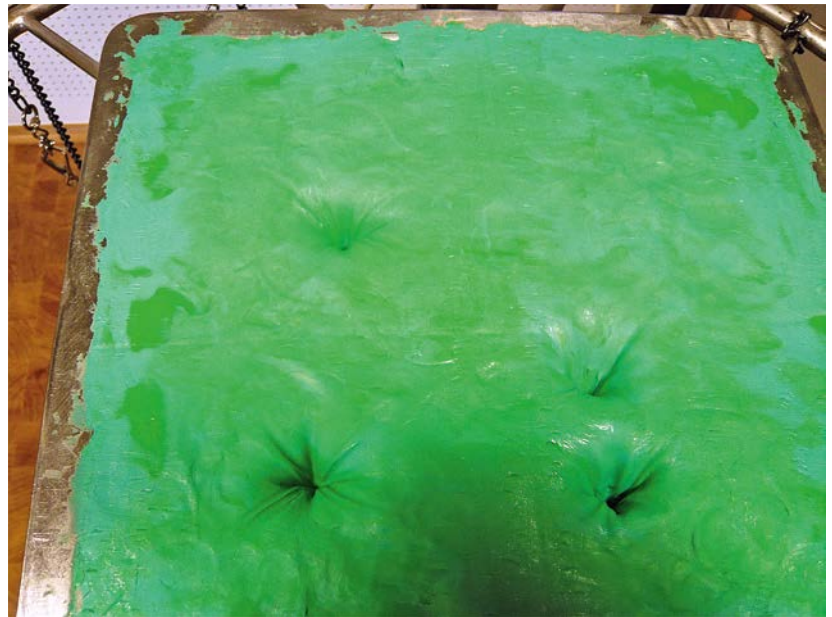
Abbildung 7: Unter dem zu prüfenden Gewebe befindet sich eine genormte Substanz, welche das menschliche Gewebe simulieren soll. Neben den deutlich sichtbaren Durchschlägen (unten) wird deutlich, dass – auch wenn die Hose „hält“ – mit blauen Flecken zu rechnen ist.
