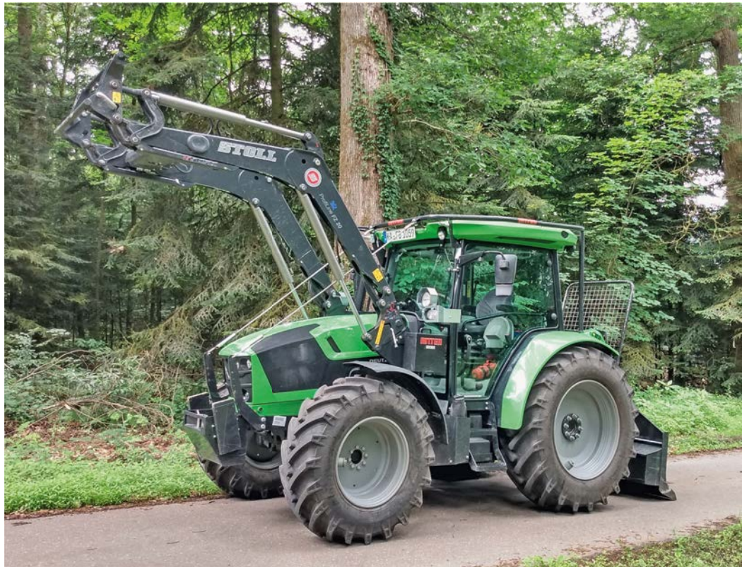
Abbildung 8: Forstraktor Typ „Deutz 5100 G“ mit Forstausrüstung Bauart Ritter (Bild Lippert)
