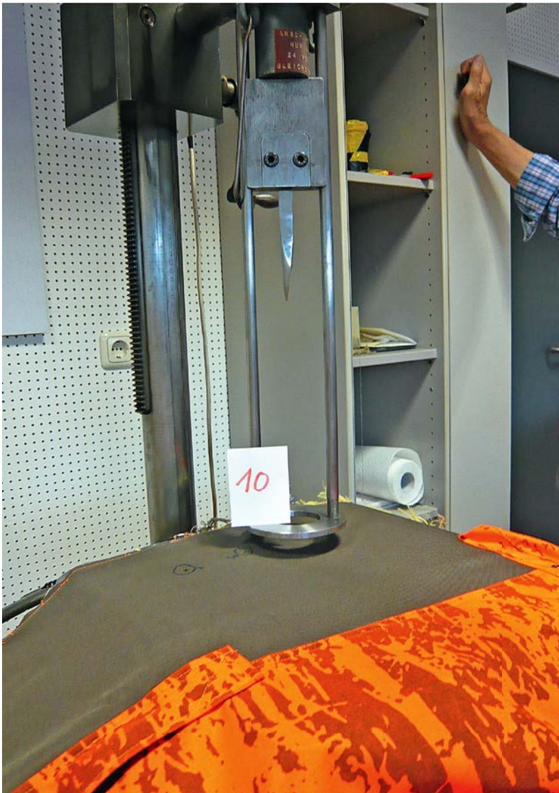
Abbildung 3: Durch zahlreiche Vorversuche an – durch verschiedene Hersteller zur Verfügung gestellte – Originalhosen, konnte man, Zug um Zug, die notwendige Fallenergie ermitteln.
