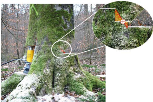
Abbildung 4: Spannungen in der Bruchleiste
