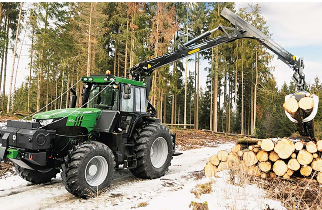
Abbildung 2: Kranrückeschlepper Typ „Kotschenreuther 240 R“ (Werkbild Kotschenreuther)
