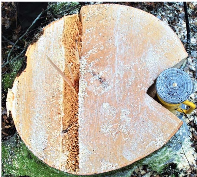
Abbildung 3: Schnittbild nach der Fällung mit einer Fällhilfe
