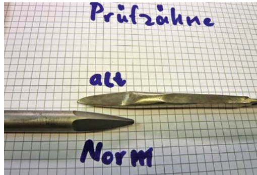
Abbildung 1: Über verschiedene Zwischenstufen gelangte man zum endgültigen Prüfzahn (unten). Norm bedeutet hier: Prüfgrundsatz
