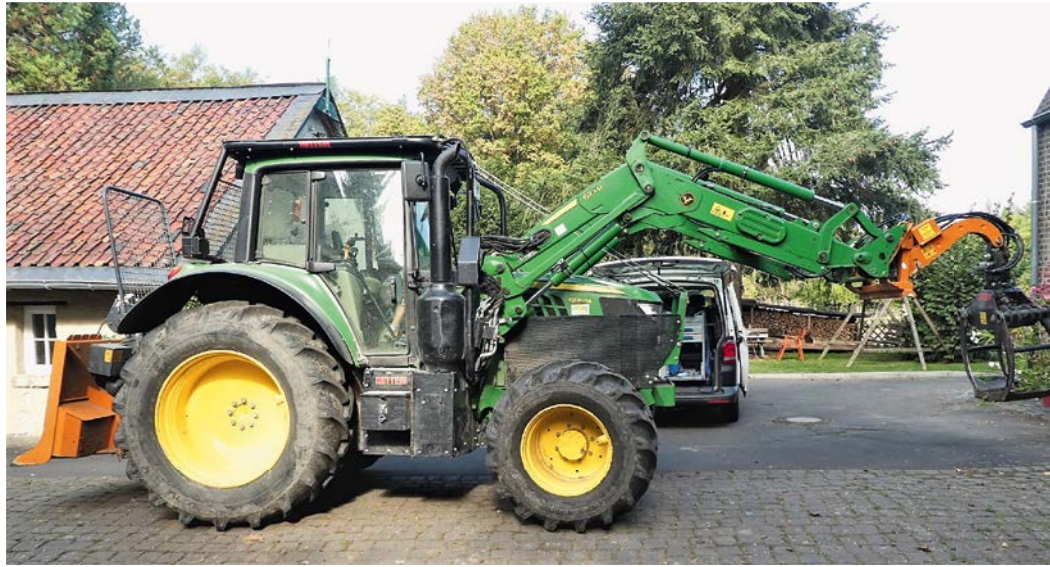
Abbildung 7: Forstraktor Typ „John Deere 6120 M“ mit Forstausrüstung Bauart Ritter (Bild Lenz)
