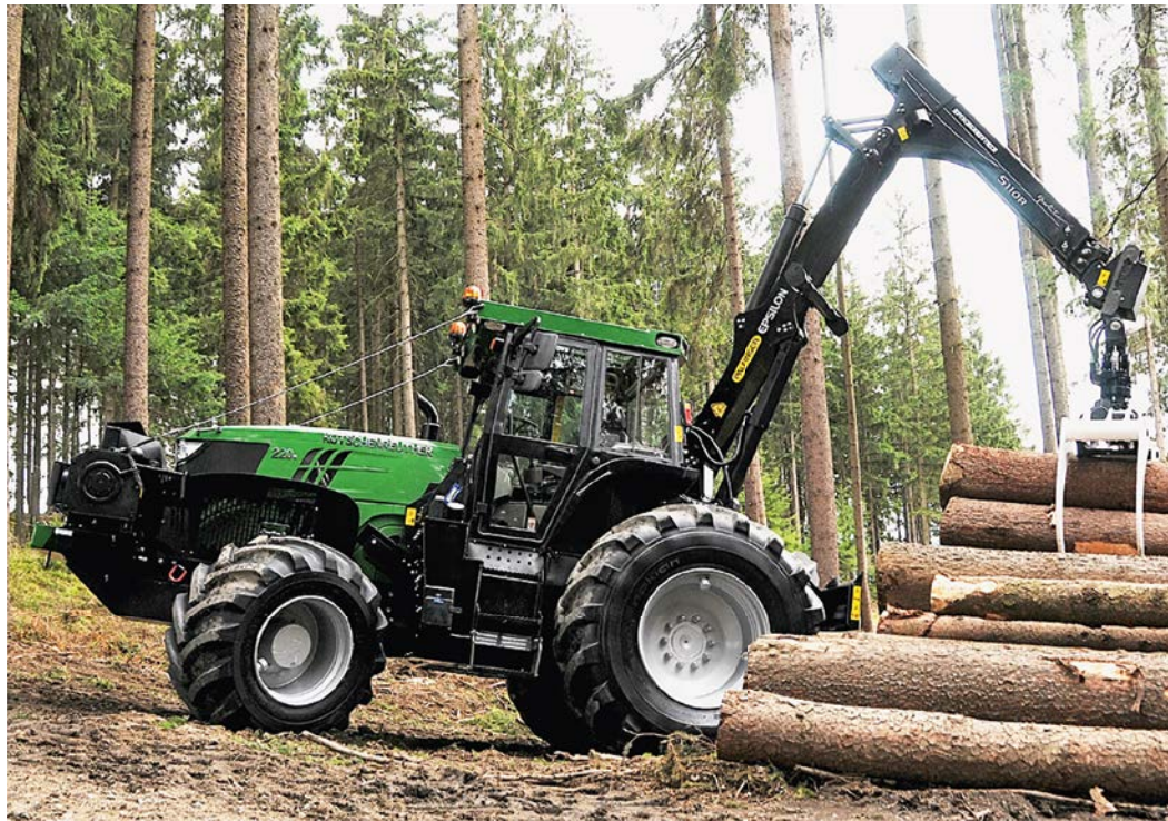
Abbildung 3: Kranrückeschlepper Typ „Kotschenreuther 260 R“ (Werkbild Kotschenreuther)
