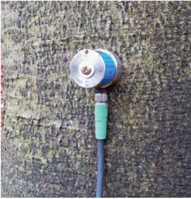
Abbildung 9: montierter Beschleunigungssensor
