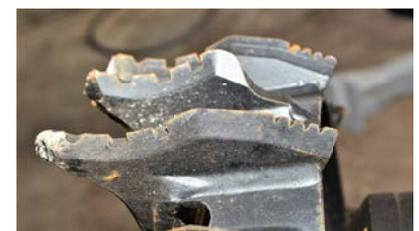
Abbildung 3: Fingerwalzenprofil der Vorschubwalzen Bauart Komatsu mit spitzem Eindringkeil und reduziertem Eindringvolumen
