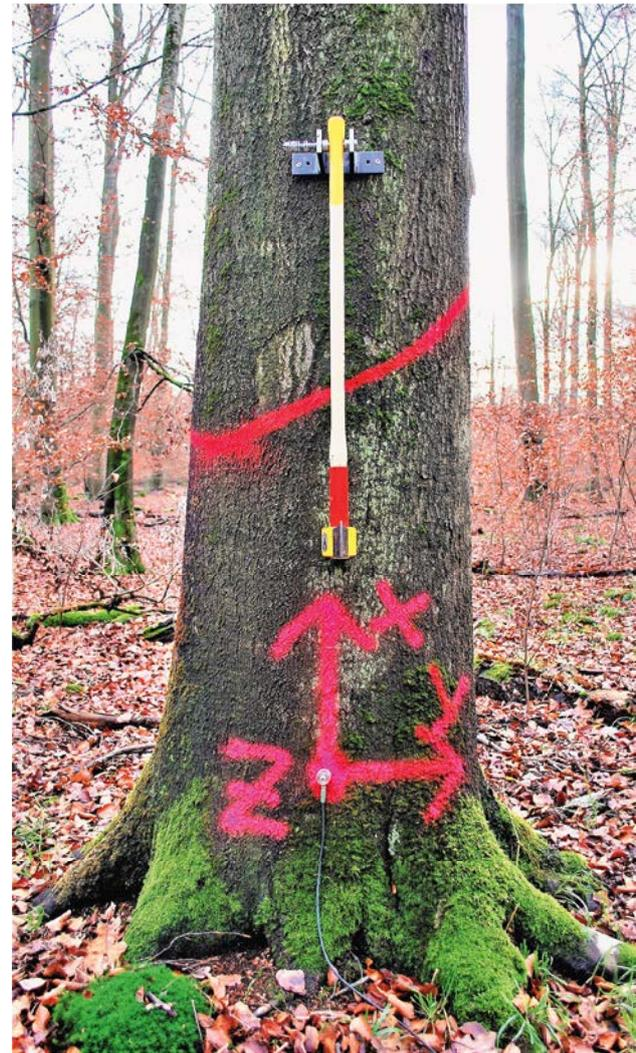
Abbildung 11: Vorrichtung zum Erzeugen eines Impulses
