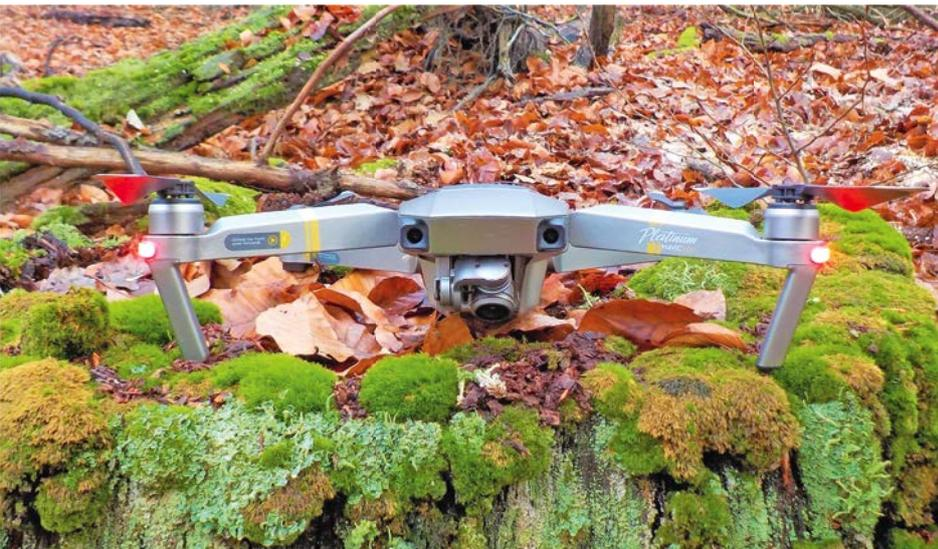
Abbildung 13: Drohne zur Videoaufzeichnung des Aufschwingverhaltens von Ästen im Kronenbereich
