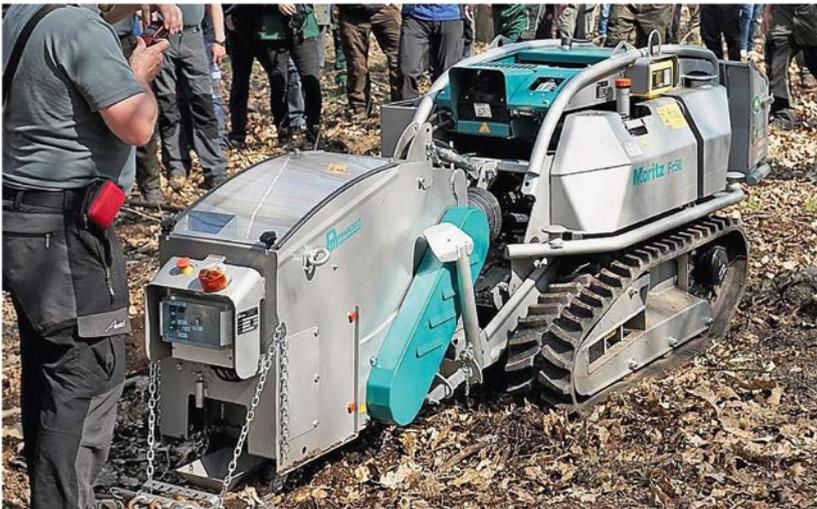
Abbildung 4: Pflanzelt Moritz Fr50 mit Anbaugerät Saat-Streifenfräse und Streifenpflug (Fotos Pflanzelt und Jassmann)
