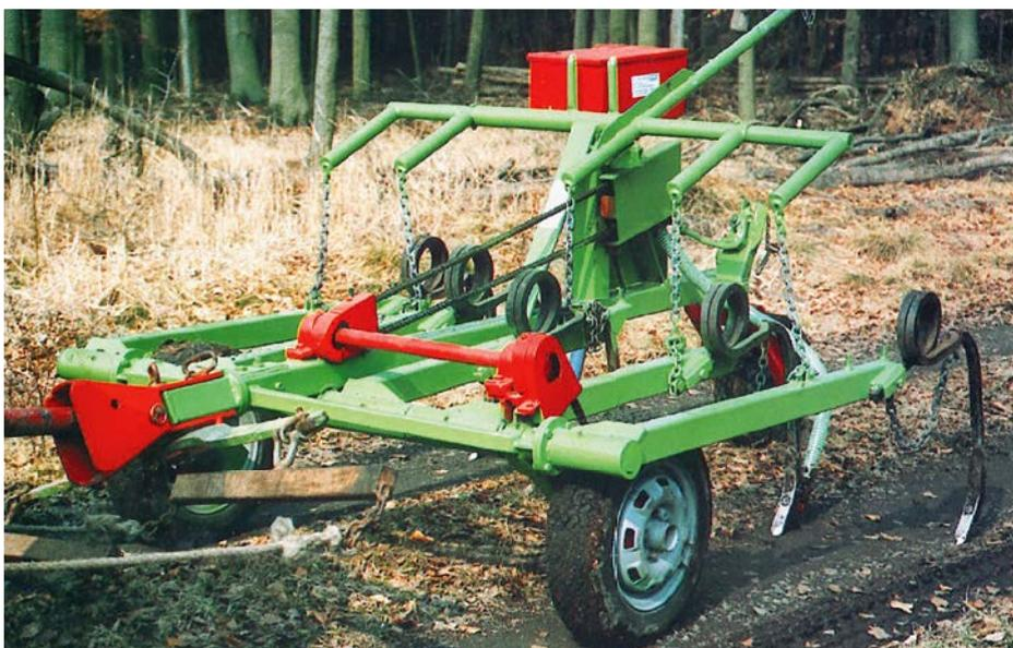
Abbildung 3: Bodenvorbereitung und Saat mit Waldgrubber Weilmünster – auf Flächen mit mittlerem Vegetationsbewuchs und vergrasten Flächen. Entwickelt wurde das Saataggregat für Bucheckern. Es wird durch Vorwärtsbewegung mittels Kettenbetrieb in Bewegung gesetzt. Die Bucheckern fallen aus einem 3 – 4 kg fassenden Vorratsbehälter in Auslaufrohre an den Scharen in die gezogenen Rillen und werden direkt in den Mineralboden eingearbeitet. (Foto KWF)
