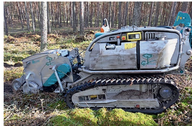
Abbildung 1: Ferngesteuerte Kleinraupe Moritz Fr50 der Firma Pfanzelt
