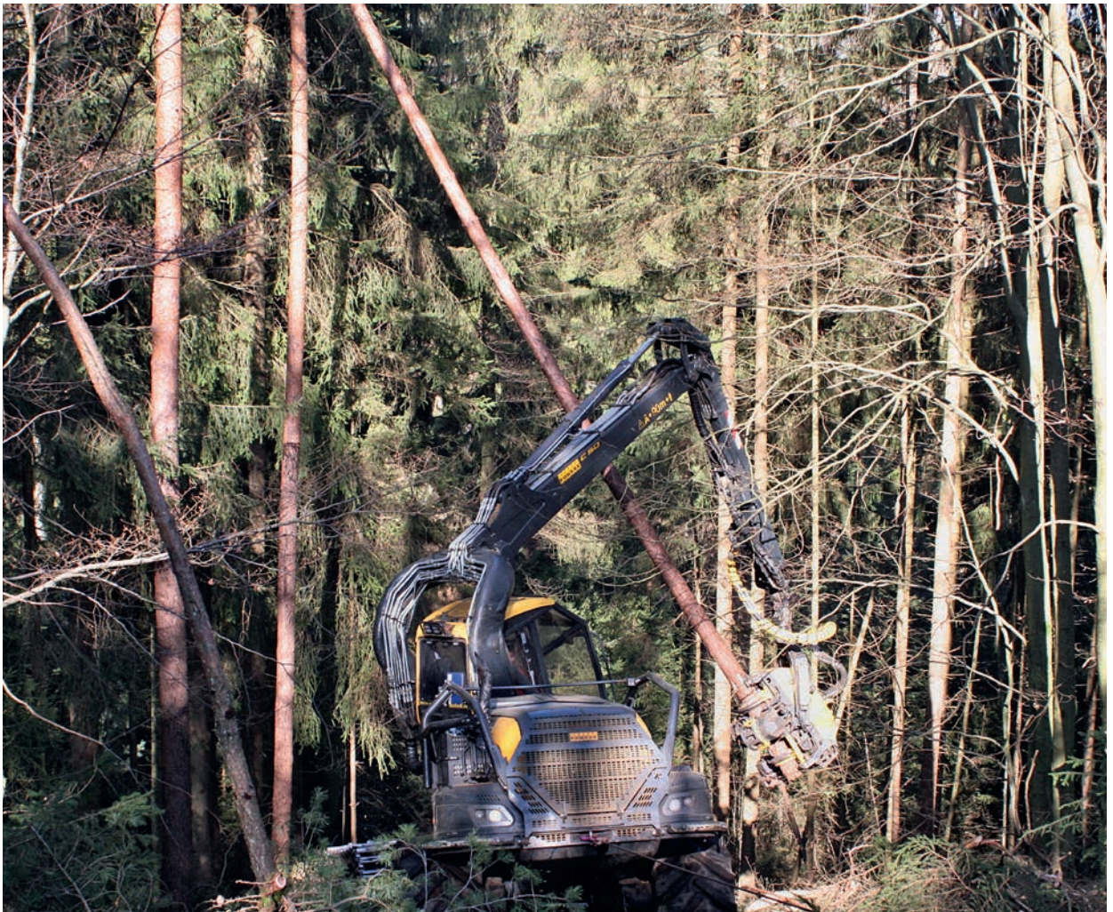
Abbildung 1: Holzernte am Hang mit einem Harvester mit Traktionshilfswinde in einem Bestand mit Durchforstungsrückständen und nicht zuletzt dadurch bedingtem, hohem Unfallrisiko bei Durchführung im motormanuellen Arbeitsverfahren.
