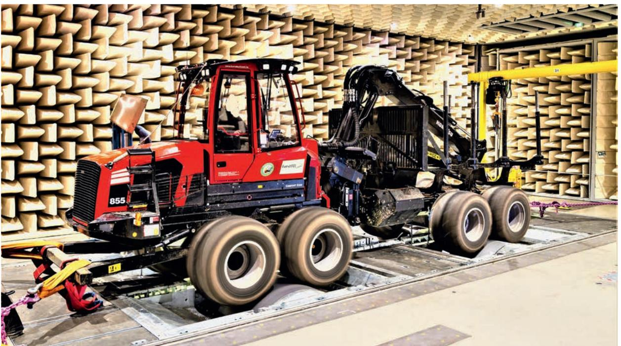
Abbildung 6: Komatsu 855 auf dem Rollenprüfstand
