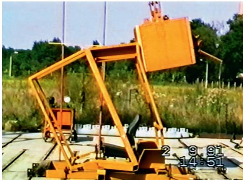
Abbildung 2: Kabinenprüfung auf Umsturzrisiko (– später Ropstest)
