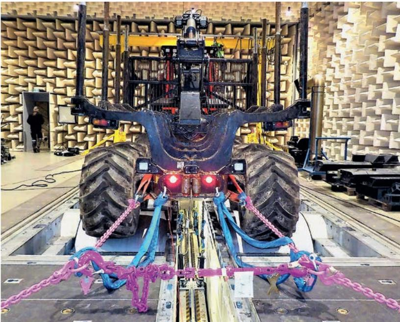
Abbildung 7: Fesselung auf dem Rollenprüfstand
