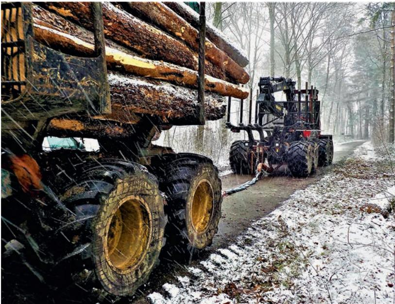
Abbildung 4: Bremsfahrzeug und Komatsu im gekoppelten Zustand
