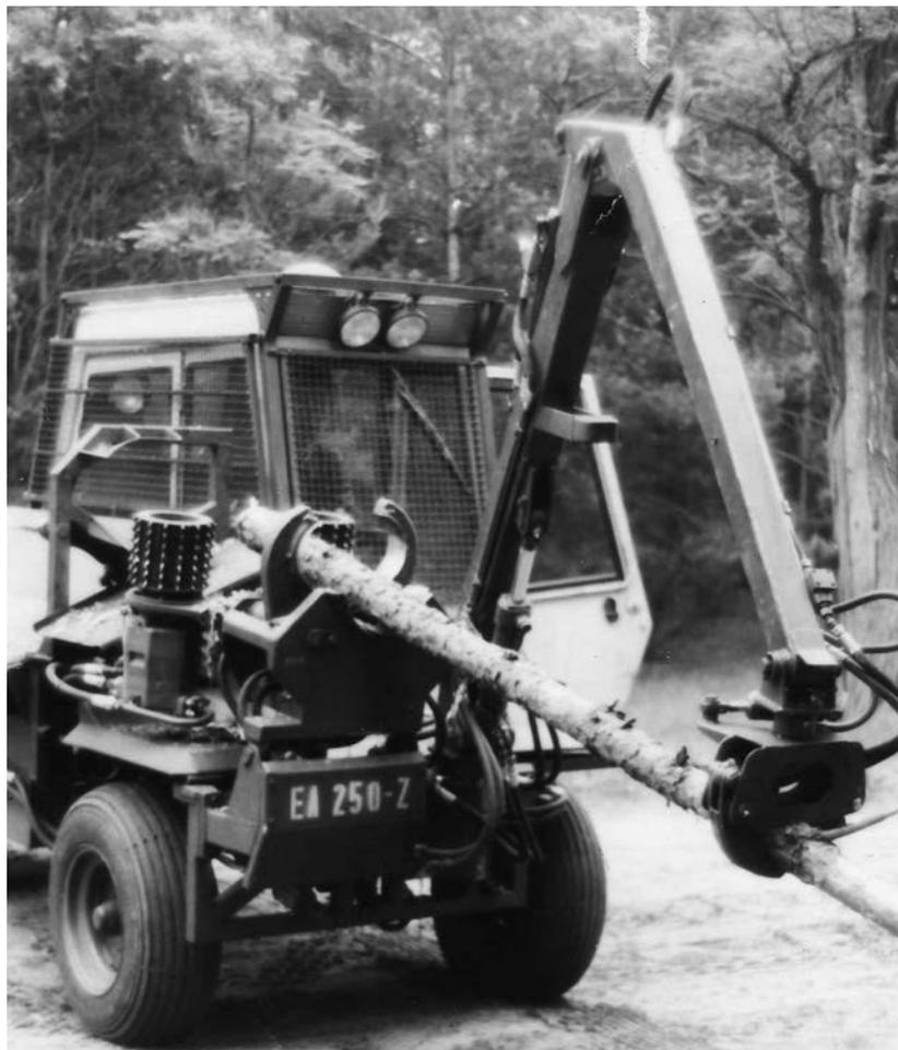
Abbildung 3: Entastungsmaschine für Dünnholz bis 25 cm Durchmesser EA 25 Z des Militärforstbetriebes Züllsdorf
