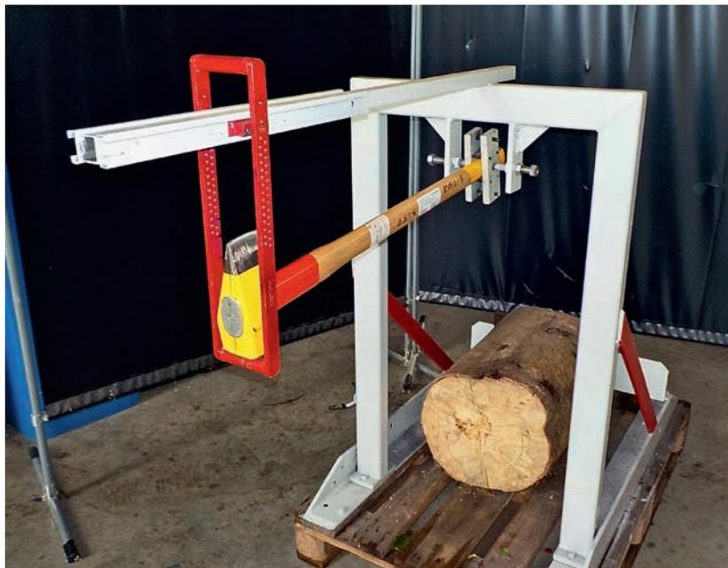
KWF Prüfstand zur Untersuchung des Schwingungsverhaltens von Werkzeugstielen
