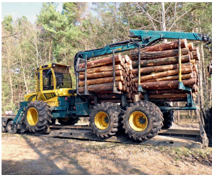
Abbildung 1: Tragschlepper HSM 208 F 6WD mit Superbreitreifen bei der Wägung.
