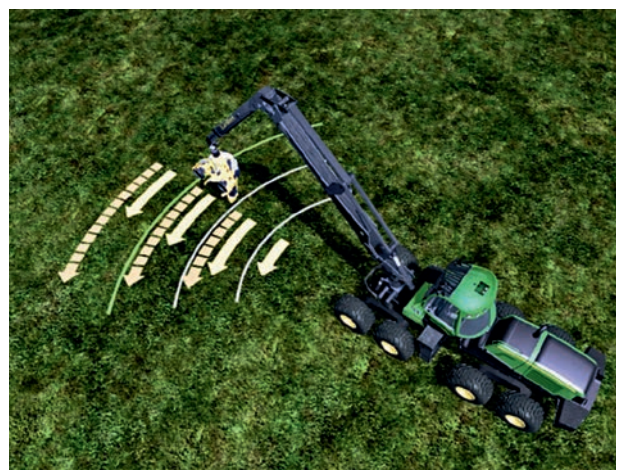
Die Umfangsgeschwindigkeit der Kranspitze wird entsprechend der Reichweite des Auslegers geregelt. Die gestrichelte Linie zeigt die Bewegungen konventioneller Systeme, die durchgehende Linie die von IBC.
