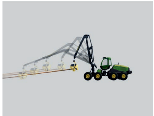
Beim „Paralleleinzug“ wird das Aggregat automatisch auf die optimale Höhe zur Verarbeitung des Baums gebracht. Die Erweiterung wird so angetrieben, dass beim Entasten die Materialermüdung des Krans verringert wird (Einzug durch das Harvester-Aggregat).
