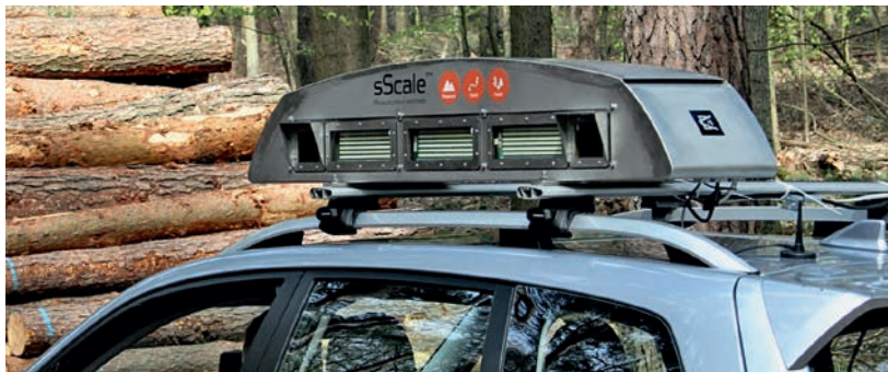
Abb. 3: sScale™ 3D-Stereokameratechnologie, kompakt und robust auf einem mobilen Trägerfahrzeug montiert
