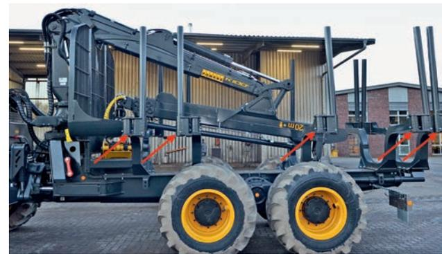
Abbildung 3: Einrichtung zur Rungenkorbverbreiterung am Forwarder „Ponsse Buffalo“ (Pfeil) durch Ausschwenken der Rungen (Foto KWF)
