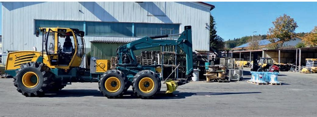
Abbildung 5: Forstspezierschlepper „HSM 805Z 6WD“ (Foto KWF)
