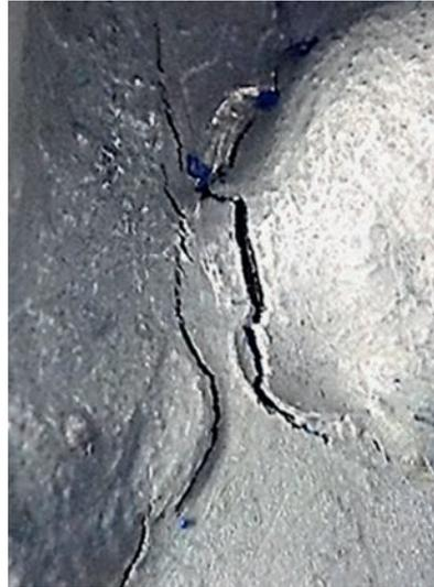
Abb. 9: Zerrung mit Anriss des Materials
