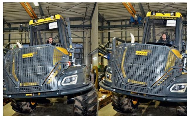
Abbildung 4: Wirkungsweise des Kabinennivelliersystems „Active Frame“ des Forwarders „Ponsse Buffalo“ (Graphik KWF)
