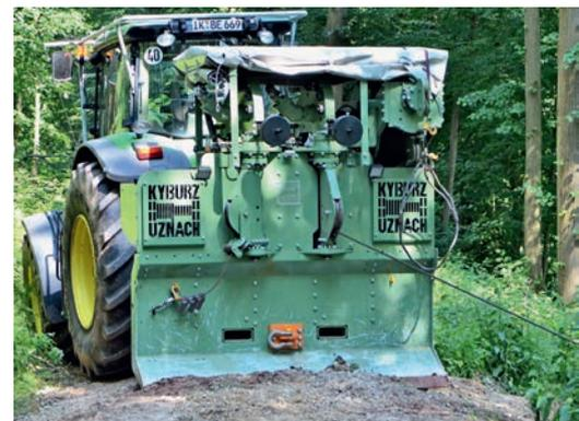
Abbildung 7: Windensystem „Kyburz Mamut“ (Foto KWF)
