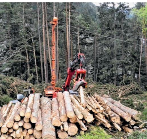
Abbildung 1: Exkursion Seilkreinsatz im Sortimentverfahren mit Bergabrückung (Foto KWF)
