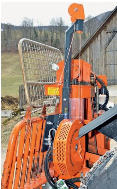
Abbildung 6: Hilfswinde Bauart „HAFO Pro“ (Foto KWF)
