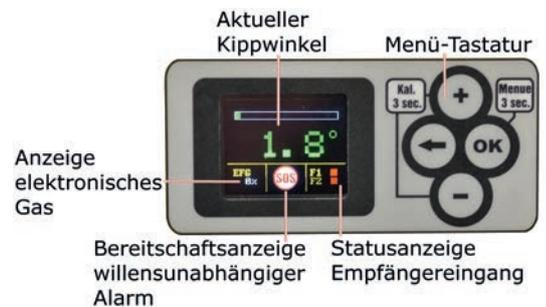
Abbildung 9: Display und Folientastatur der Funkfernsteuerung „terra FA5-D1/FA5-K1“ mit Anzeigen des aktuellen Kippwinkels und dem Status der Kippwinkelüberwachung, der Anzeige des elektronischen Gasausgangs, der Bereitschaftsanzeige des willensunabhängigen Alarms und der Statusanzeigen sowie der Bedientastatur (Graphik KWF)
