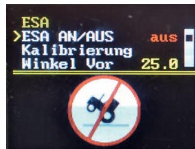
Abbildung 10: Kalibrierbildschirm Funkfernsteuerung „terra FA5-D1/FA5-K1“ (Graphik KWF)
