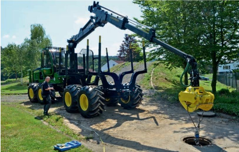
Abbildung 1: Hubkraftmessungen an einem Forwarder Bauart John Deere
