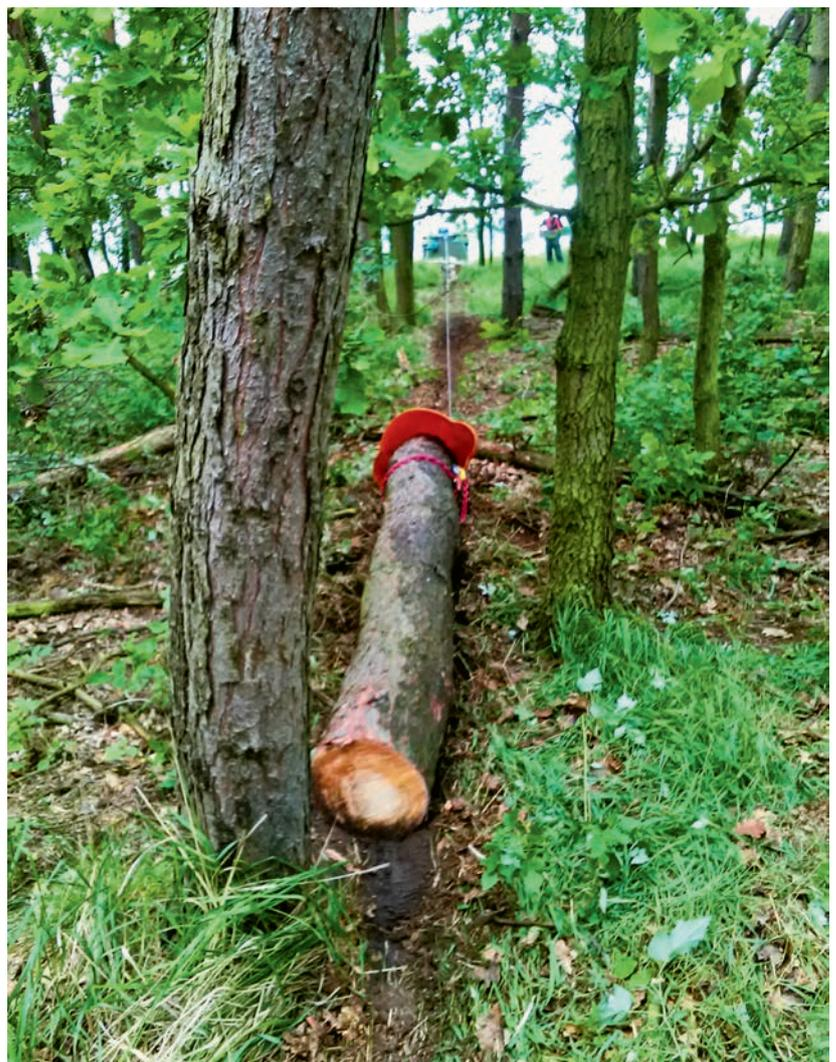
Abb. 2: Rückehaube im Einsatz beim Verfahren mit geschlossenem Seilkreislauf
