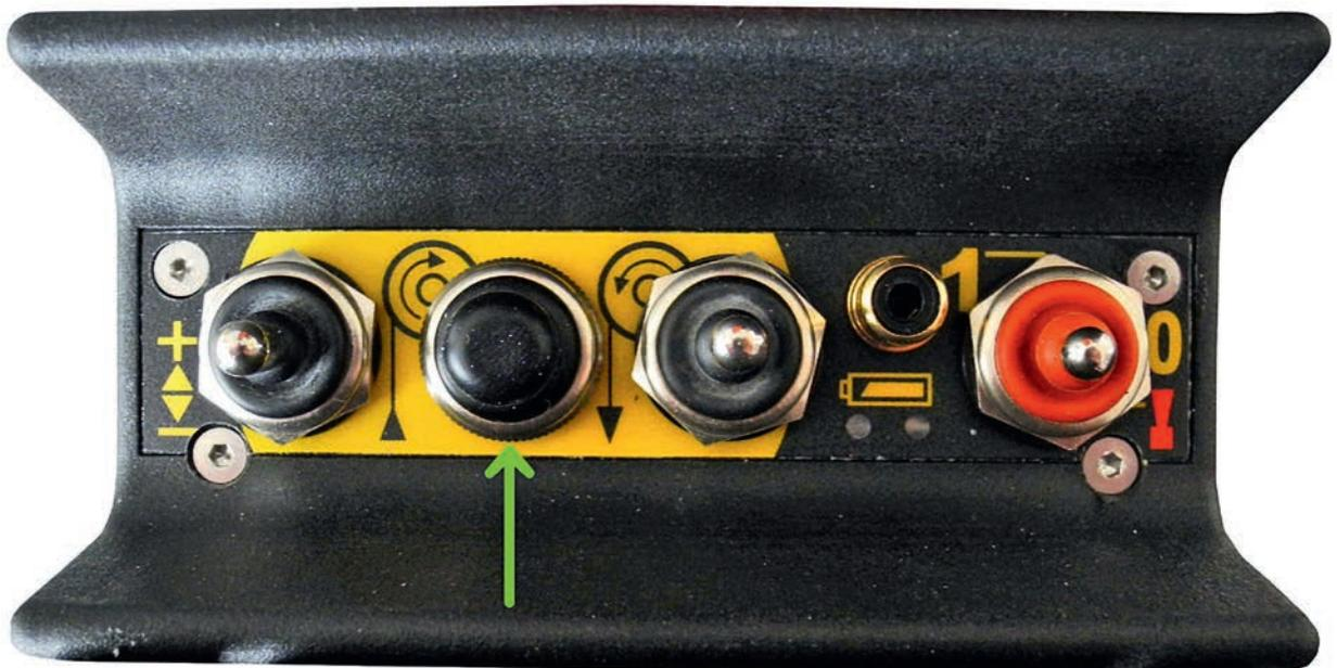
Abbildung 3: Druckknopfschalter für die Funktion „Einziehen“, der keine weitere Funktion schaltet (monofunktionaler Drucktaschalter mit selbsttätiger Rückstellung)
