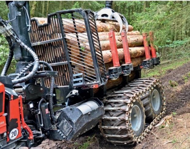
FOTO: Integrierte Traktionshilfswinde an einem Forwarder (Foto Weise)
