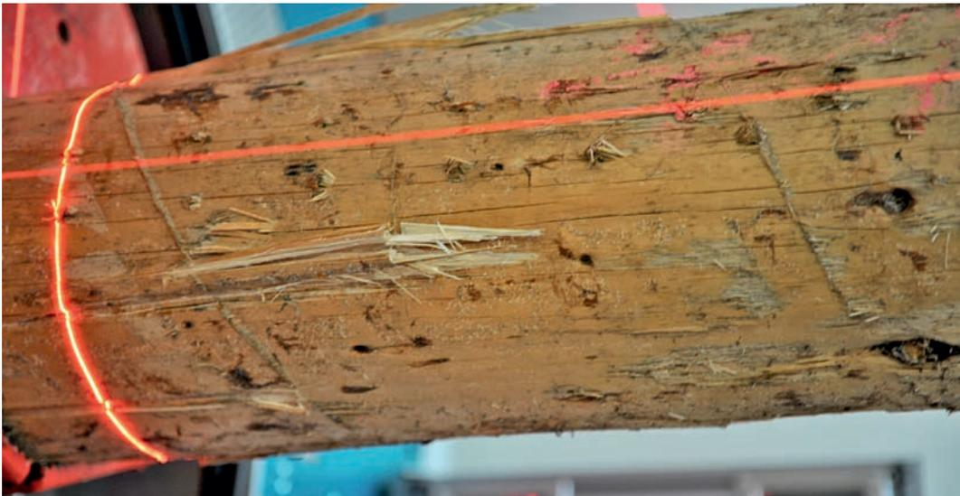
Elektronische Rundholzvermessungsanlage (3D-Vermessung, Lasertriangulation)
