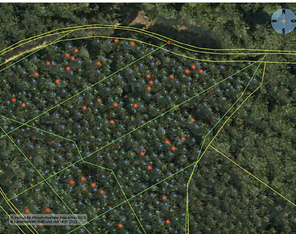
Der zentrale Faktor bei der Rückegassenplanung ist der Rückegassenabstand. Bei dem von der FSC vorgeschriebenen Abstand von 40 Metern können nicht alle Bäume mit Harvester gefällt werden, obwohl sie ausgezeichnet sind (rot markierte Bäume im Bild).
