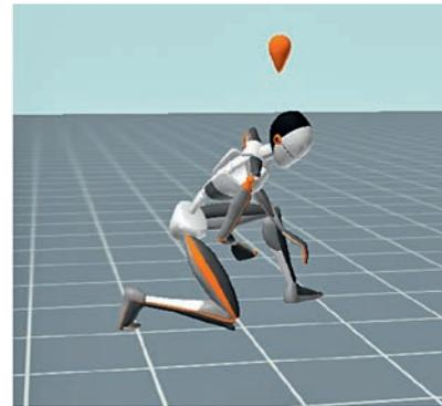
wertungsverfahren sollen durch Überführung der ermittelten Motion Capture-Daten in das digitale Menschmodell CharAT Ergonomics ergonomische Untersuchungen möglich werden.
