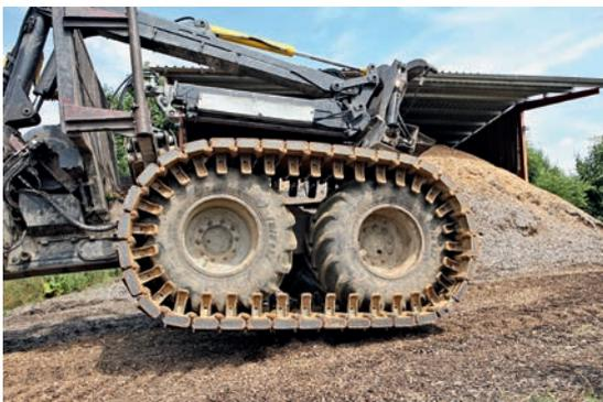
Abbildung 1: Forwarder mit Marquardt Band auf einer Punktbelastung
