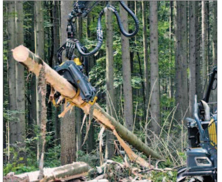
Ponsse-Harvester mit Debarking Head (Entrindungskopf) im Einsatz: Für eine möglichst vollständige Entrindung muss das Holz mehrfach durch das Aggregat gelassen werden. Foto: J. Grünberger
