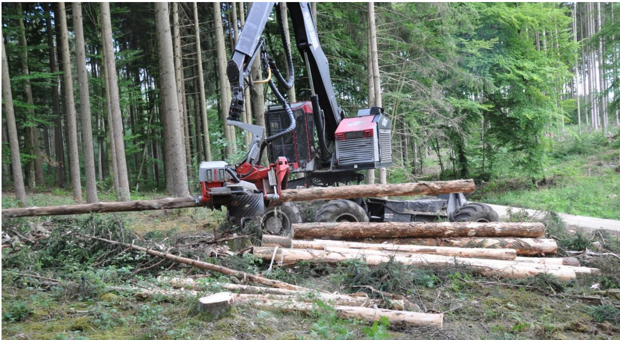
Foto: Versuch (Bayern, Käferholz) aus dem Verbundvorhaben: Nährstoffentzug bei der Holzernie minimieren - durch die Nutzung von entrindenden Harvesterfällköpfen (FKZ: 22012214)
