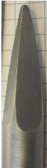
Abb. 4: Der Prüfdorn wurde dem Zahn eines etwa 3 – 4-jährigen Kellers nachgebaut. Der Radius der Spitze entspricht dem ermittelten Durchschnit aus Messungen an mehreren Original-Kellierzähnen
