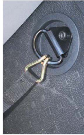
Für den Transport verwendete Fahrzeuge und Anhänger müssen über Zurrpunkte verfügen, an denen Lasten befestigt werden können. Dabei ist deren maximale Belastbarkeit zu beachten.
