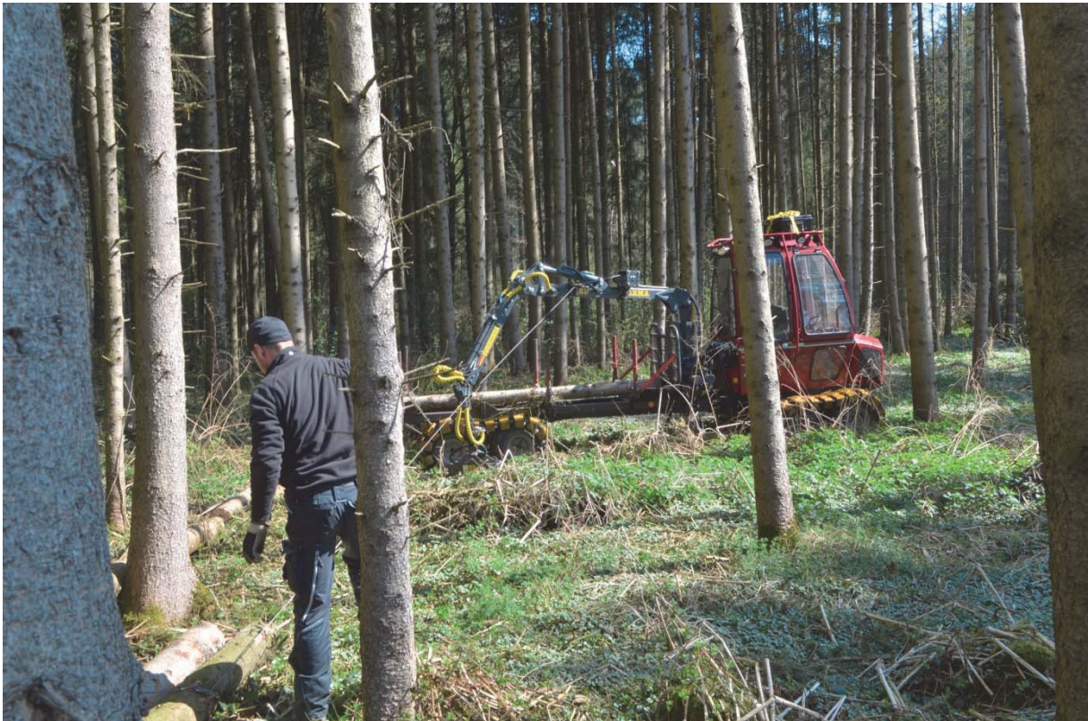
Mini-Forwarder Bauart Alstor 823 während der Einsatzuntersuchung durch das KWF
