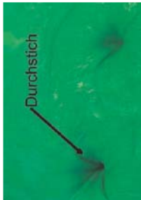
Abb. 4: Der Prüfdorn wurde dem Zahn eines etwa 3 – 4-jährigen Kellers nachgebaut. Der Radius der Spitze entspricht dem ermittelten Durchschnit aus Messungen an mehreren Original-Kellierzähnen
