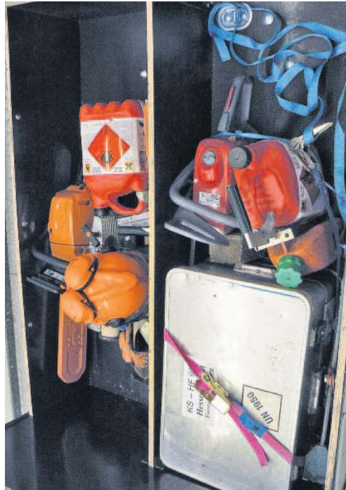
Ordnungsgemäß gesichert: Auch in Kurven oder bei einer plötzlichen Bremsung ist nicht zu befürchten, dass die Ladung verrutscht.
