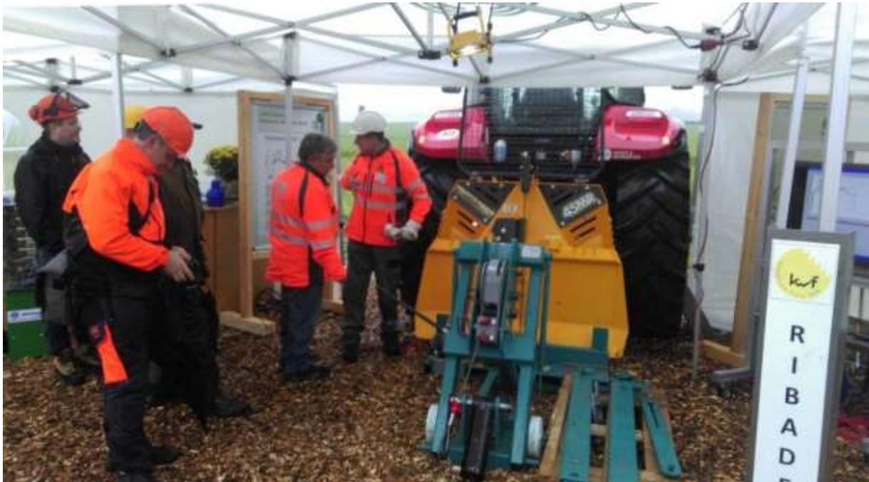
Vorführung der Seilwindenprüfung mit dem modifizierten Windenprüfsystems RiBaDe während der KWF-Thementage in Groß-Heins
