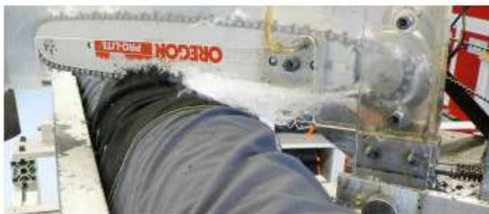
Auf dem Prüfstand im KWF-Technikum muss der Schutzabschirm einer These beweisen, dass er einer Motorsäge standhalten würde. Fast alle Thesen werden mit 20 m/s (Schwertschneidgeschwindigkeit) geprüft. Das ist für nahezu jeden in der Praxis ausreichend.
