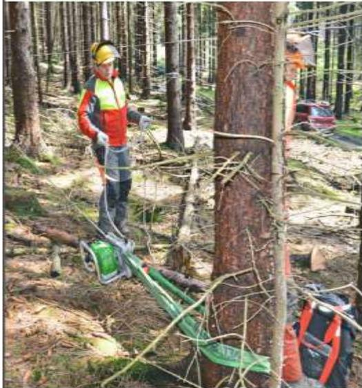
Abb. 4: Vorbereitung einer seilunterstützten Fällung mit Seilumlenkung
