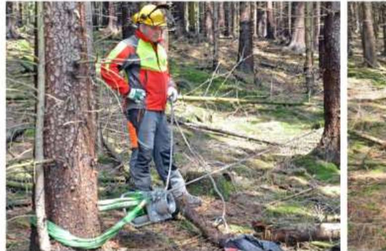
Abb. 1: Befestigung der Winde von der in Zugrichtung gesehen rechten Seite
